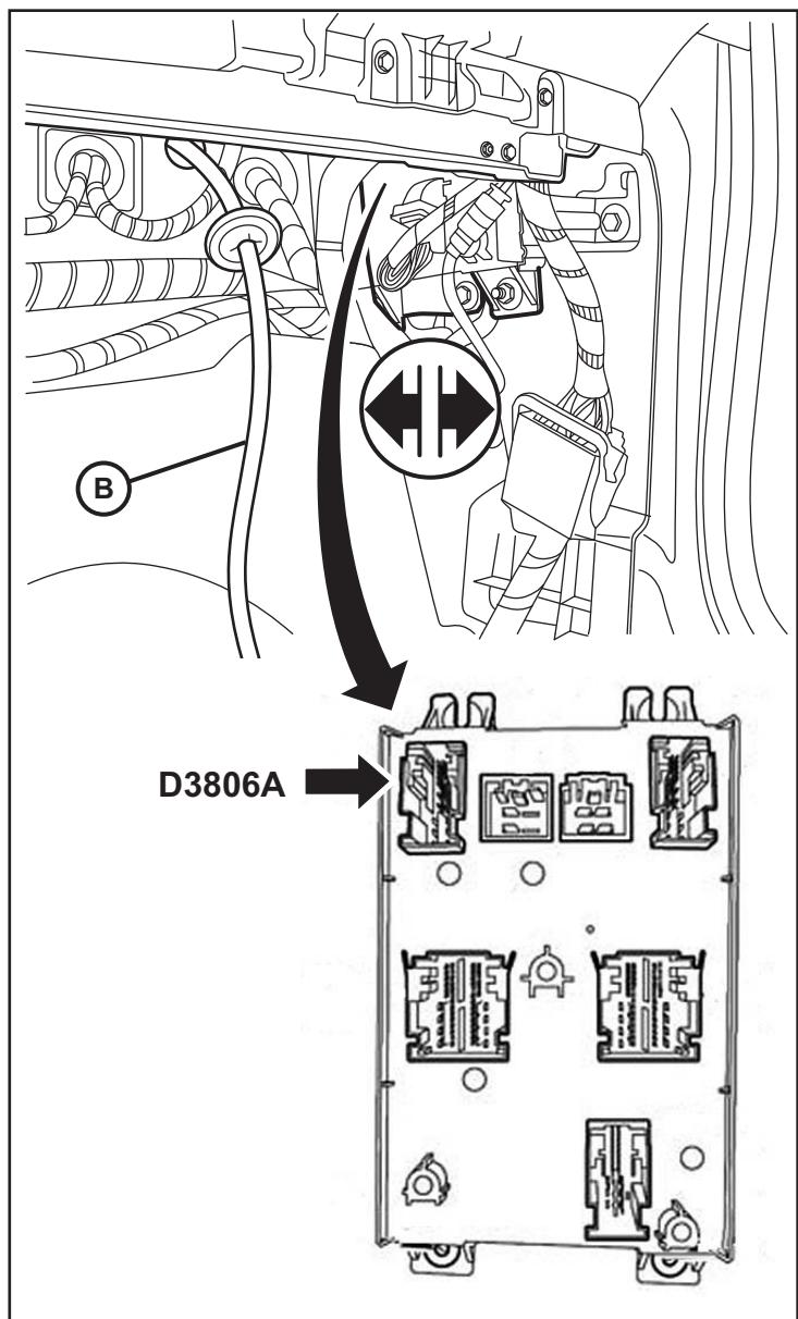
23. Separe del BCM el enchufe del conector superior izquierdo. Oprima las lengüetas de liberación en la parte trasera del conector y deslice el enchufe hacia afuera de la funda exterior.
