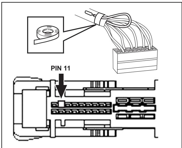
25. Insérez le connecteur de fil provenant du faisceau de câbles du commutateur (B) dans la broche 11 du connecteur.
