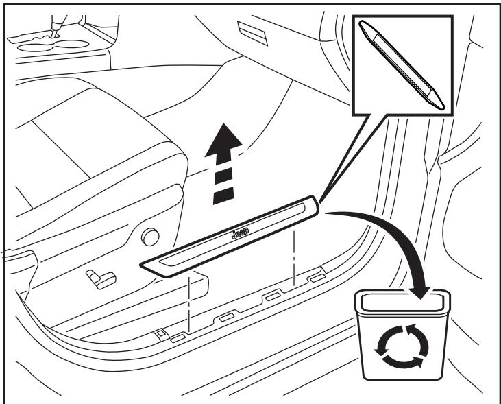
13. Déposez la garniture coupe-bise du côté extérieur du puits de jambe puis soulevez délicatement le panneau de garniture extérieure du puits de jambe.
