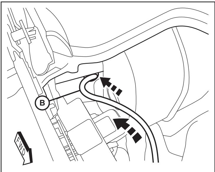
21. Recorte un orificio de acceso a través del ojal y pase el mazo del interruptor a través de la abertura.
