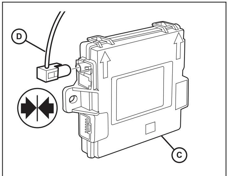
34. Placez le nouveau module routeur RF (C) en position. Fixez le module routeur RF au mur avec deux (2) écrous hex. (F) et rebranchez tous les connecteurs de faisceaux de câbles.
