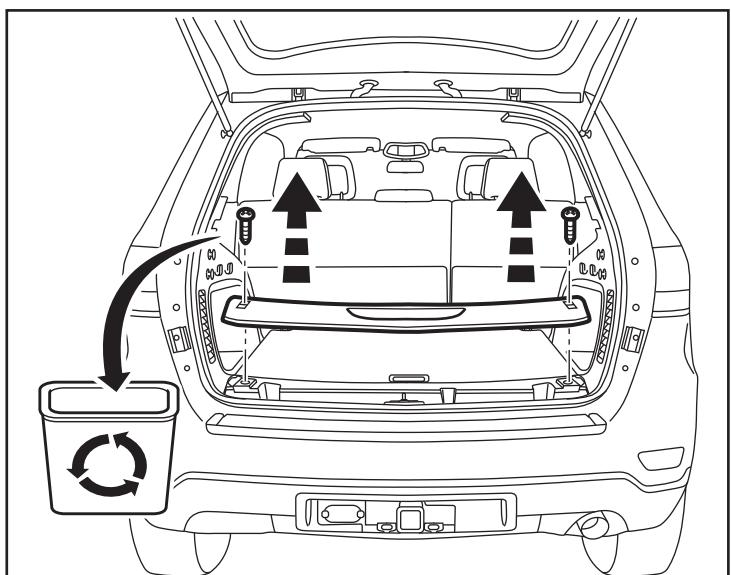
30. Retire el panel de la cubierta de carga del vehículo.
