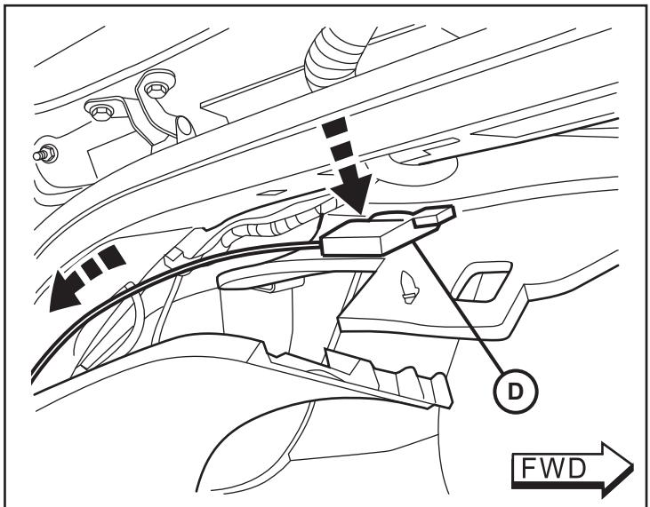
38. À l'aide de ruban d'électricien, fixez le faisceau de câbles du module d'antenne (D) le long du faisceau de câbles existant du véhicule à l'intérieur du montant arrière.
