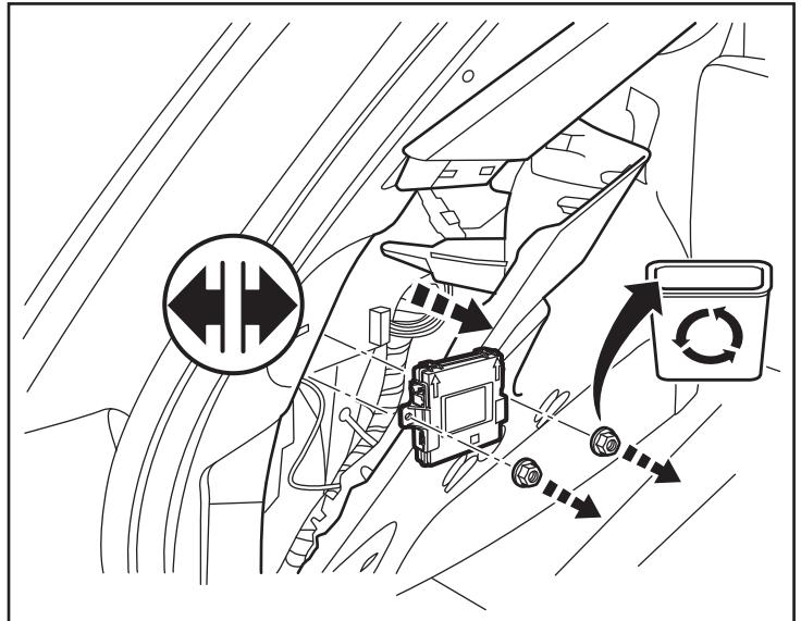
33. Branchez le câble du module d'antenne (D) dans le nouveau module routeur RF (C).
