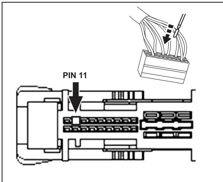
26. Vuelva a instalar la funda exterior sobre el conector. Enchufe todos los conectores al BCM.
