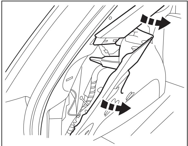
32. Localice el módulo de distribución RF existente en el poste del lado del conductor del área de la compuerta trasera. Desconecte todos los conectores de los mazos. Quite dos (2) tuercas de sujeción hexagonales. Retire el módulo de distribución RF.
