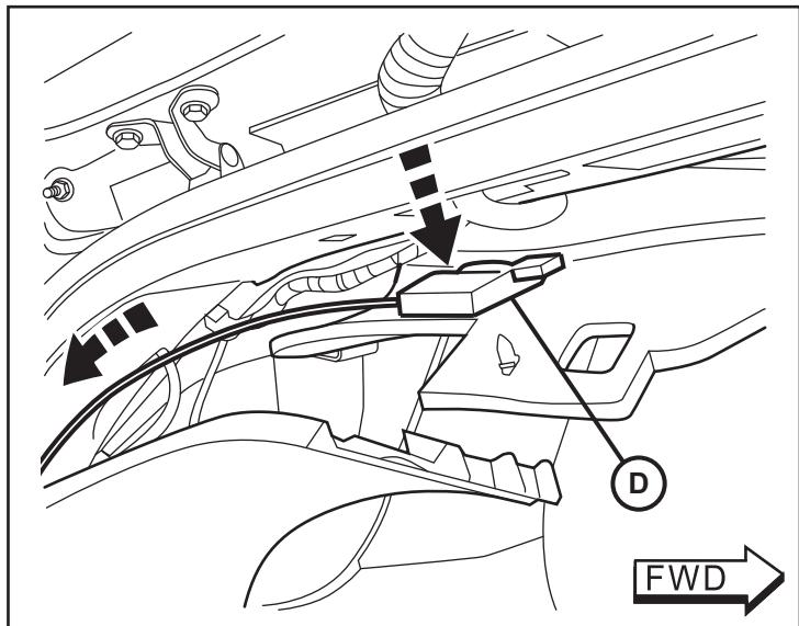
38. Sujete el mazo del módulo de la antena (D) junto con los mazos existentes en el vehículo dentro del poste trasero utilizando cinta de aislar.
