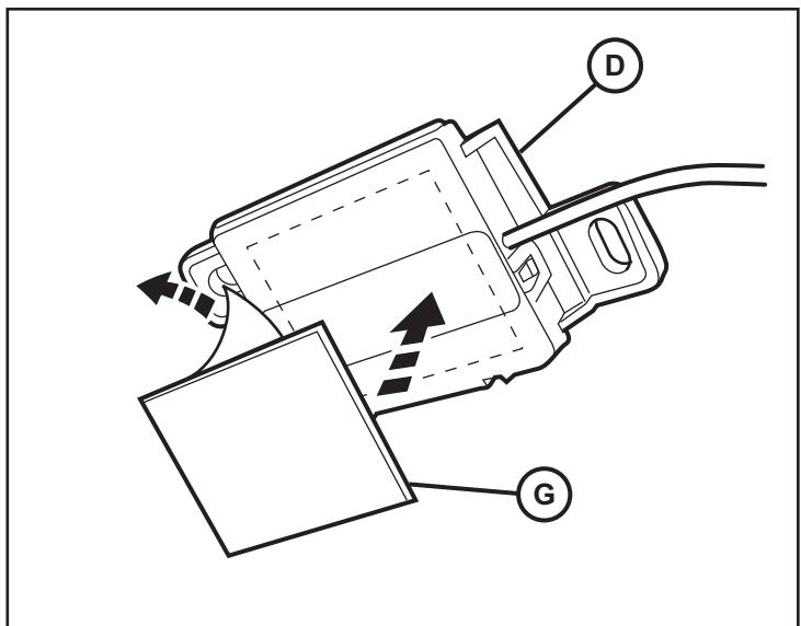
37. Desprenda el otro lado del panel con doble lado adhesivo (G) e instale el Módulo de la antena (D) en el interior del toldo. Encause el cable del conector hacia abajo en dirección al poste del lado del conductor dentro de los paneles de vestidura.
