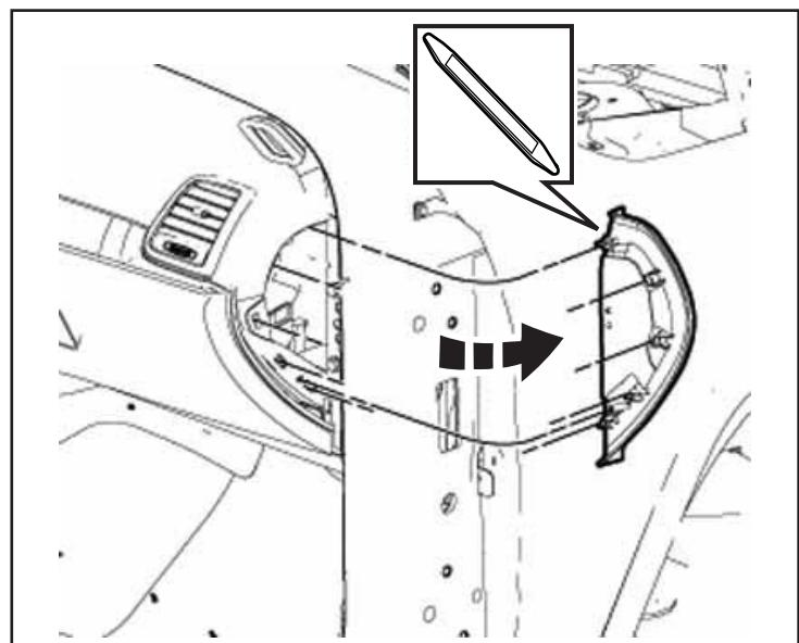
16. Abra la puerta de la guantera. Desconecte el cable amortiguador de la guantera. Oprima dos (2) lengüetas de tope. Abata la puerta hacia abajo, libere las bisagras de la puerta y retire la puerta de la guantera.
