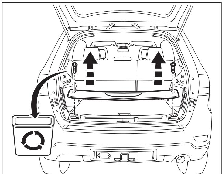
30. Déposez et sortez du véhicule le panneau de plancher du coffre.
