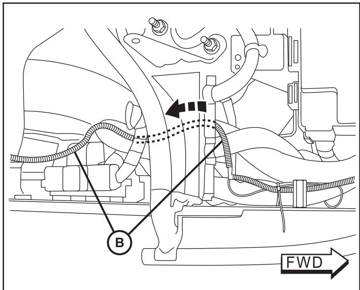
11. Tendez le faisceau du commutateur (B) en repoussant tout excédent vers l'arrière du compartiment moteur. Fixez les deux faisceaux ensemble avec des serre-câbles (E).
