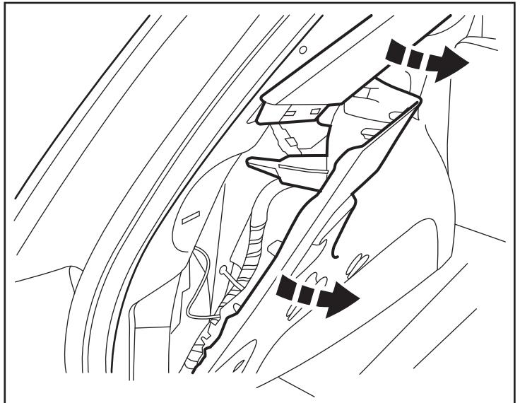
32. Localisez le module routeur RF existant sur le montant du hayon arrière côté conducteur. Débranchez tous ses connecteurs de faisceaux de câbles. Déposez deux (2) écrous hex. de montage. Déposez le module routeur RF.
