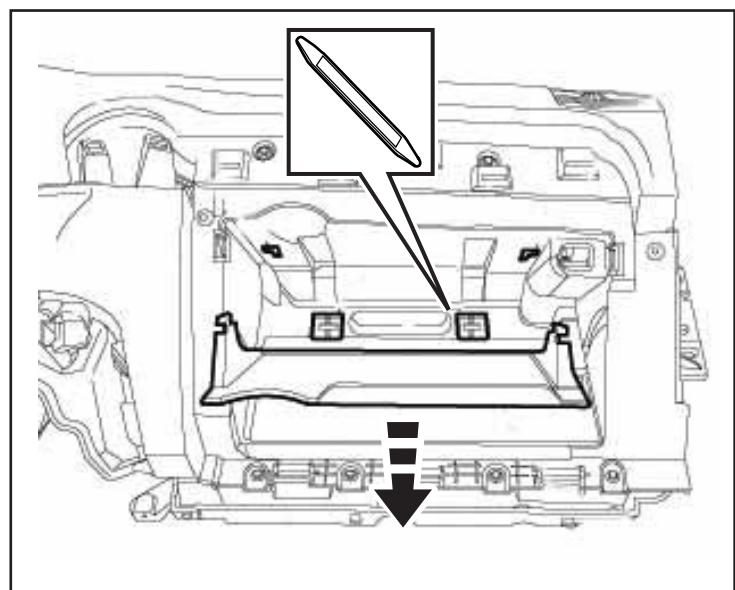
18. Quite cuatro (4) sujetadores del borde inferior y dos (2) sujetadores ocultos con tapas de goma en el borde superior del contorno de la guantera. Desconecte un (1) conector eléctrico situado en el lado derecho del contorno de la guantera. Retire el contorno de la guantera del vehículo.
