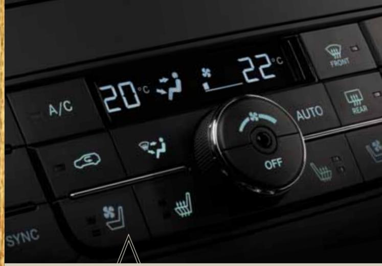
**CLIMATIZADOR BIZONA.** Disfrute de la temperatura ideal configurándolo en modo AUTO (automático). Este sistema de climatizador autorregulable deshumedece el aire entrante para un mayor confort. Esto ayuda a reducir la acumulación de condensación en el parabrisas y las ventanillas laterales.
