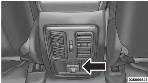
Inversor de corriente
