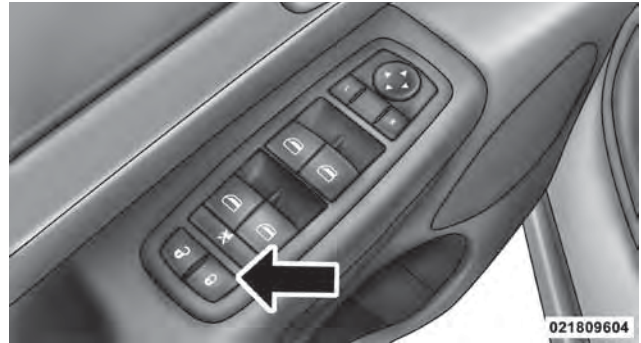
Interruptor de los seguros eléctricos de las puertas
