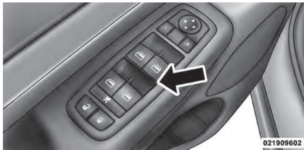
Interruptores de las ventanas eléctricas
