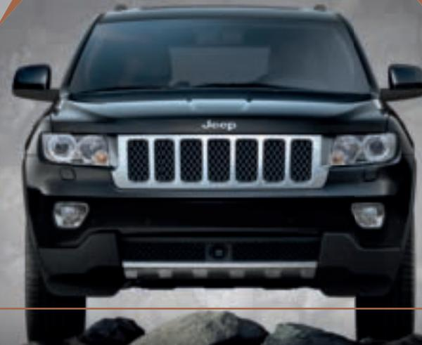
En relevant le véhicule de 65 mm, la garde au sol atteint 271 mm et permet d'aborder des conditions sortant de l'ordinaire.
