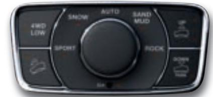
» **QUADRA-DRIVE® II.** Ce système 4x4 met la performance à portée de main. Un différentiel électronique à glissement limité (ELSD) transfère jusqu'à 100% du couple aux roues motrices et vous aide à avancer dans toutes situations.
