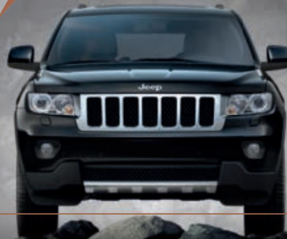
Se obtiene una altura libre al suelo de 271 mm al levantar el vehículo 65 mm para que pueda enfrentarse a condiciones fuera de lo normal.
