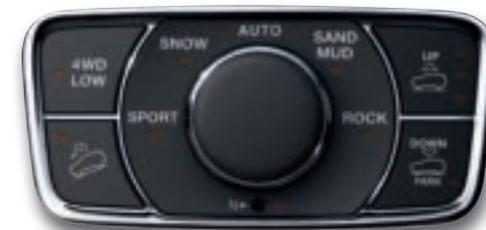
» **SELECT-TERRAIN®.** Escoja uno de los cinco modos distintos para adaptarse a las condiciones de la carretera. Select-Terrain coordina muchos sistemas a la vez, incluidos la asistencia de arranque en cuesta (HSA), el control de descensos (HDC), el control de tracción, el control electrónico de estabilidad (ESC),<sup>7</sup> así como la transmisión, los diferenciales y el motor, para proporcionar una mayor tracción en todo momento.
