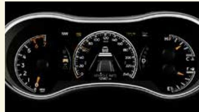
Instrumentenanzeige mit konfigurierbarem 7-Zoll-TFT-Farbdisplay
