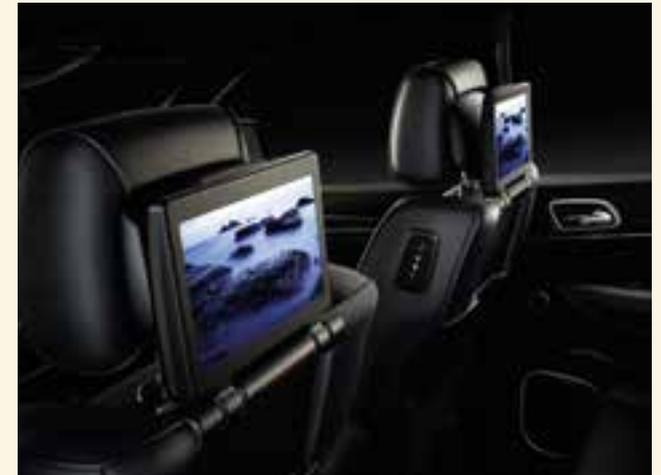
Zwei schwenkbare 9-Zoll-VGA-Displays sind in die Rückenlehnen integriert, um die Passagiere im Fond zu unterhalten. Das System spielt DVDs und Blu-rays ab. Beide Bildschirme verfügen über unabhängige HDMI- und Audio-/Video-Eingänge für den Anschluss externer Geräte (z. B. Blu-ray-Player, Spielekonsole). Außerdem dabei: eine Fernbedienung und zwei drahtlose Kopfhörer.
