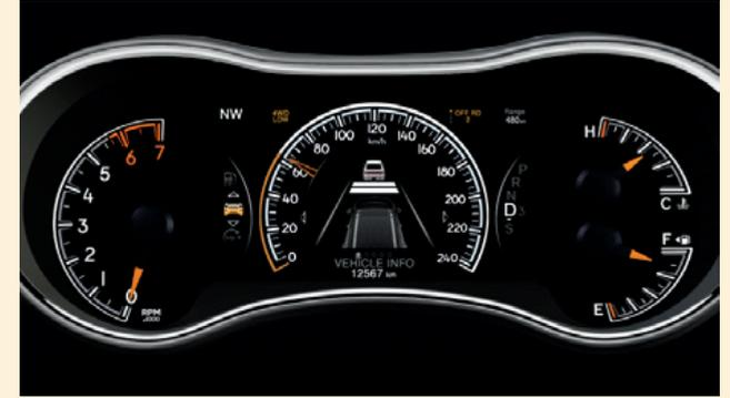
Instrumentenanzeige mit konfigurierbarem 7-Zoll-TFT-Farbdisplay
