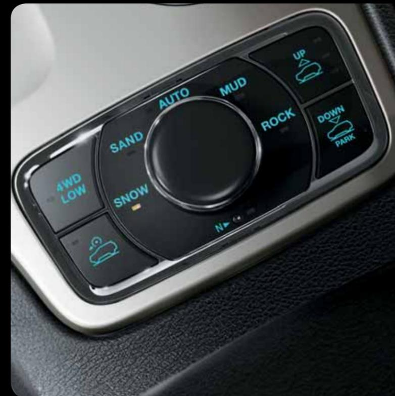
Con cinque impostazioni selezionabili e grazie al coordinamento di ben 12 diversi sistemi di gestione del veicolo, tra cui quello per il controllo dell'acceleratore, per il cambio marcia, per la scatola di rinvio, per il controllo della trazione e per il controllo elettronico della stabilità, cresce
