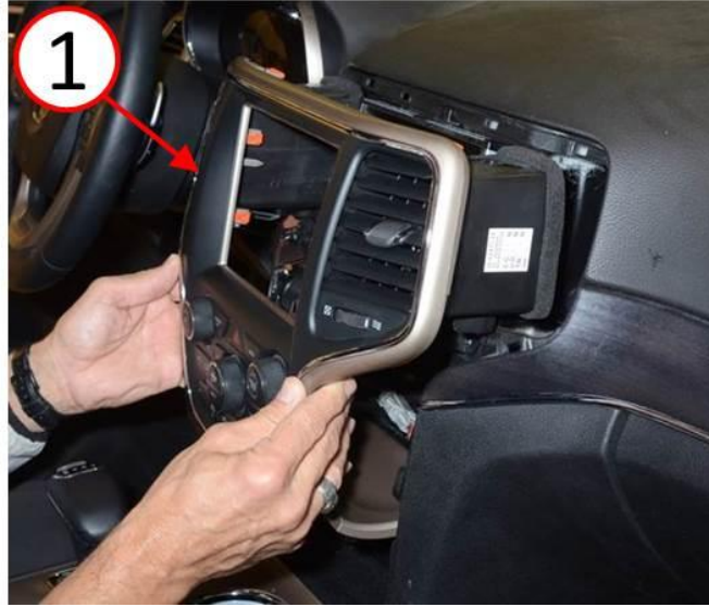
Fig. 13 ICS Bezel Installation
