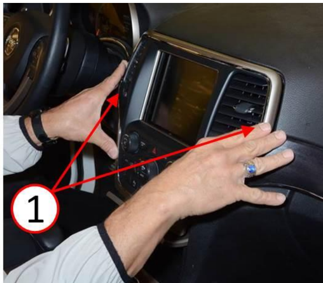
Fig. 14 ICS Bezel Installation
